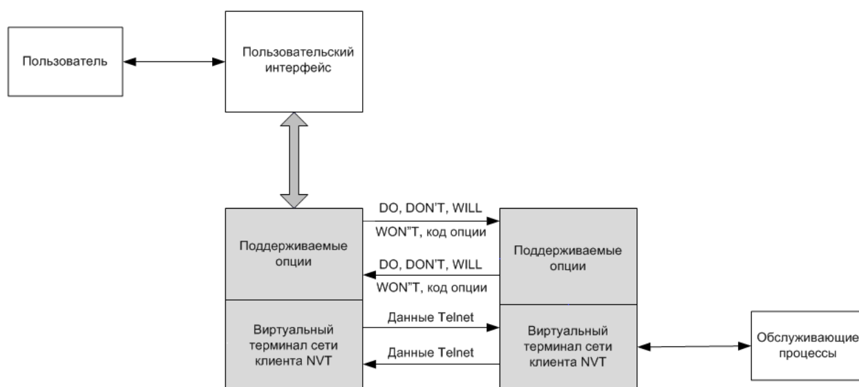
Рисунок 3.9 – Передача данных по протоколу Telnet
